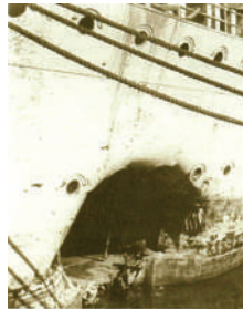
Figuras 52 y 53: Arriba, el destructor republicano José Luis Díez fondeado en Gibraltar poco después de recibir un impacto de artillería del crucero Canarias en su banda de babor y muy cerca de la proa y de su línea de flotación (marcado con una X). Abajo, detalle del citado impacto de artillería en el casco del buque. (Archivo Rolandi.)
