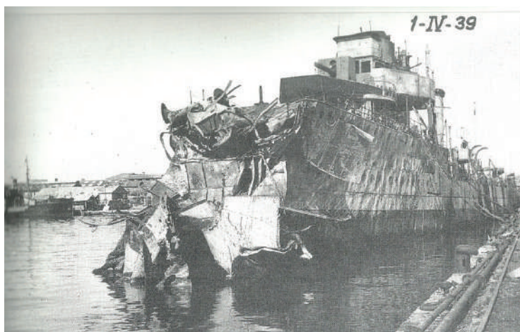
Figura 10. Efectos en el destructor Sánchez Barcaiztegui de los bombardeos de la aviación nacional sobre la Base Naval de Cartagena del 5 de marzo de 1939
