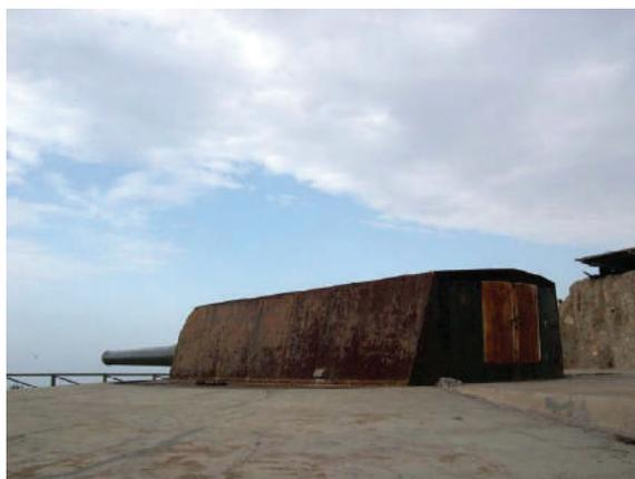
Figura 7: Fotografía de una batería de costa con las potentes piezas Vickers de 38,1 cm y 45 calibres, que lanzaban proyectiles de 885 kg, con un alcance máximo de 35,1 kilómetros
